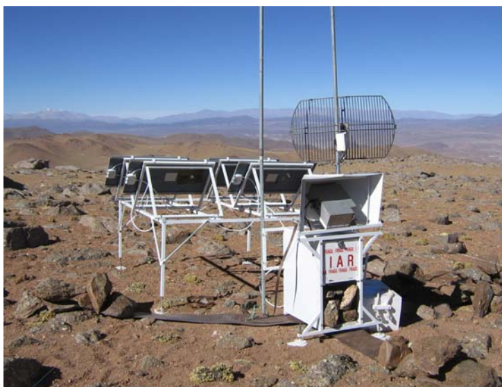
Figura 4: Vista panorámica del otro sitio pre-seleccionado, en la región de Alto Chorrillo, localizado a una altura de 4800 m.s.n.m. Al frente se observa el radiómetro y accesorios para determinar la opacidad atmosférica de la zona.
