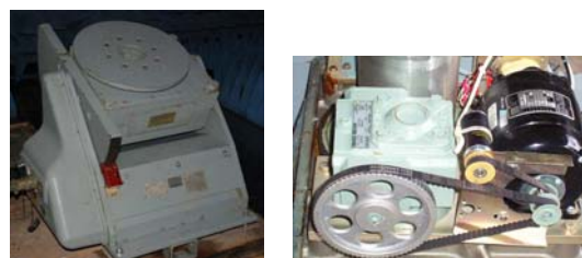
(a) Posicionador Scientific Atlanta 53050A (b) Conjunto electromecánico para el movimiento en azimut.
