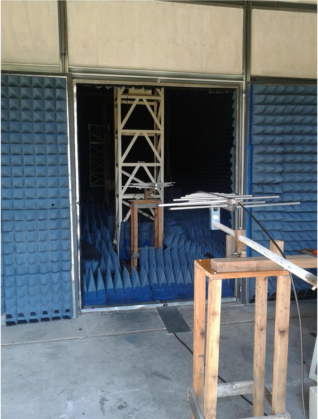
Figura 40. Medición de blindaje con antenas logoperiódicas.
