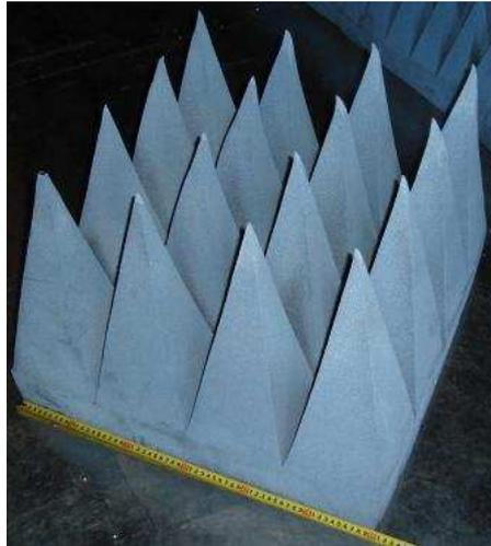
Figura 2.11: Panel absorbedor utilizado en el interior de la cámara anecoica del IAR
