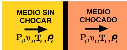
**Figura 2.4:** Esquema en el sistema de referencia con la onda de choque en reposo, la misma se representa con la línea negra. En el sistema de laboratorio, el frente de choque se mueve de derecha a izquierda. El choque divide al fluido en dos regiones: una “pre-choque” (no perturbada) y “post-choque” (perturbada). Las flechas indican la dirección de movimiento del material en cada zona.
