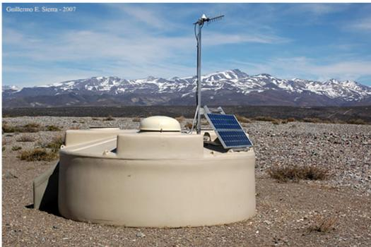
(a) Tanque Cherenkov del Observatorio Pierre Auger, ubicado en Malargüe.
