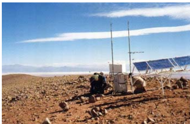
Figura 4. Instalación del instrumento Tipper en la cordillera de Macón, a 4610m de altura sobre el nivel del mar. Su propósito es medir la permeabilidad de la atmósfera al pasaje de microondas astronómicas de longitudes milimétricas y submilimétricas.
