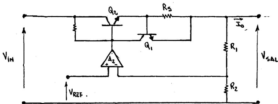
Consta de una resistencia sensora  $R_s$  en serie con la carga y de un transistor de protección  $Q_1$  que se encuentra normalmente cortado, actúa limitando la corriente de salida del regulador cuando su diferencia de potencial  $V_{be}$  supera un cierto valor umbral  $V_p$  de modo que:
