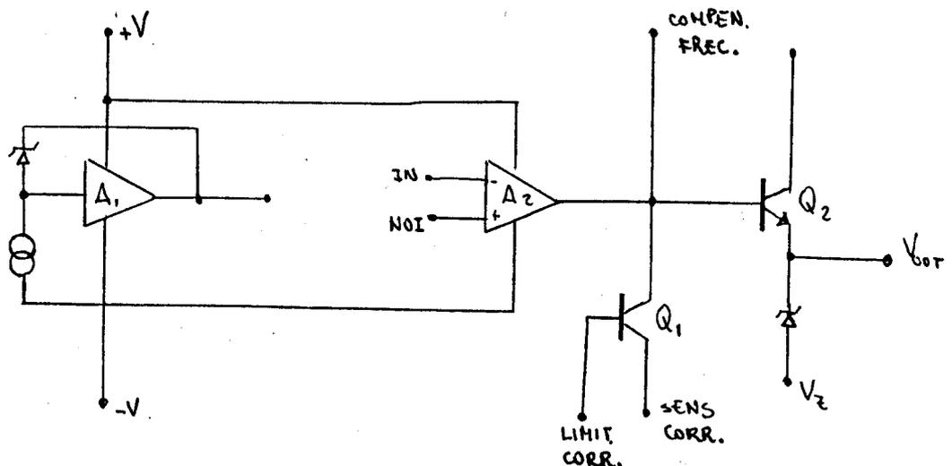
A<sub>1</sub>: amplificador de tensión de referencia
