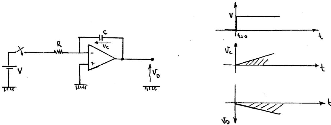
Al cerrar la llave, el valor de la corriente depende solo de  $R$  (tensión de compensación  $V_o = 0$ ) y a medida que transcurre el tiempo (carga de  $C$ ), la tensión  $V_o$  se incrementa, en forma de rampa, con polaridad opuesta a la rampa de carga del capacitor ( $V_c$ ). Al pasar el transitorio (baja frecuencia) el capacitor es un circuito abierto, entonces no hay realimentación y la transferencia del sistema es la de lazo abierto, entonces  $V_o$  es igual a la tensión de alimentación.
