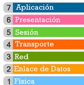
Figura 4.2: Capas del Modelo OSI
