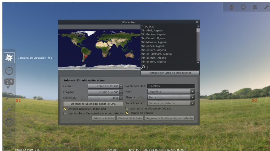
Figura 5.13: configuración de coordenadas locales dentro de stellarium
