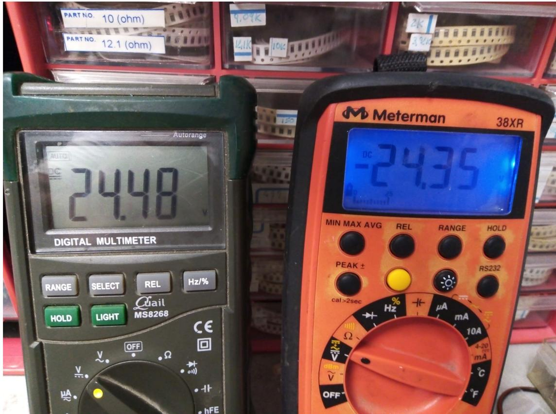
Figura 9.4: Multímetros durante la prueba del puente H, el tester meterman 38XR, mide la tensión del puente H relacionado a la altura o elevación, el otro, se asocia a la otra salida del puente H
